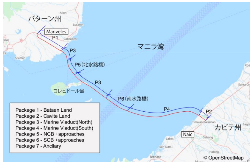
図6 バターン・カビテ連絡橋工区図
